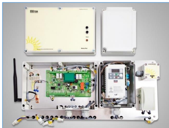
Fot. 77. Wnętrze systemu karty sterującej obserwatorium
