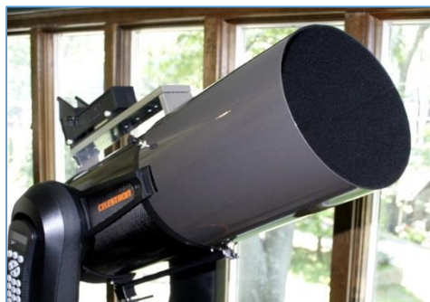
Fot. 52. Odraszacz założony na tubus teleskopu
