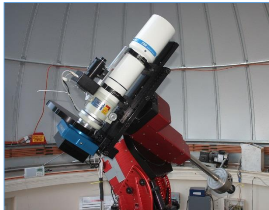
Fot. 73. Zaawansowany astrograf do fotografii szerokokątnej
